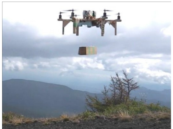
Fig. 3: 飛行ロボットのペイロード切り離し試験
