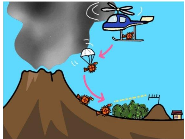
図 1 無人ヘリコプタと小型移動ロボットの複合システムによる無人調査手法のイメージ
