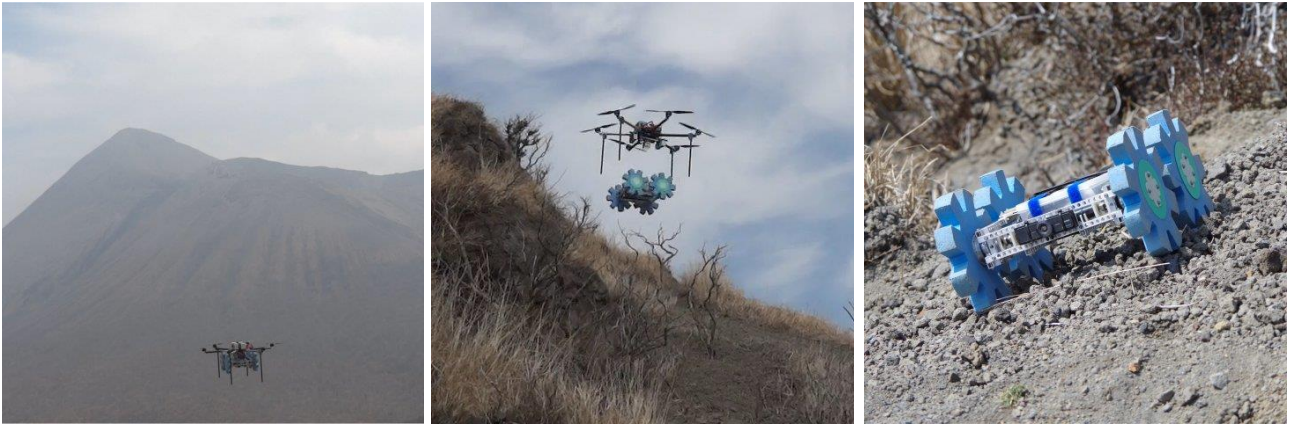
図 6 飛行ロボットによる小型移動ロボットの運搬(左)/投下(中)/遠隔走行試験(右)
