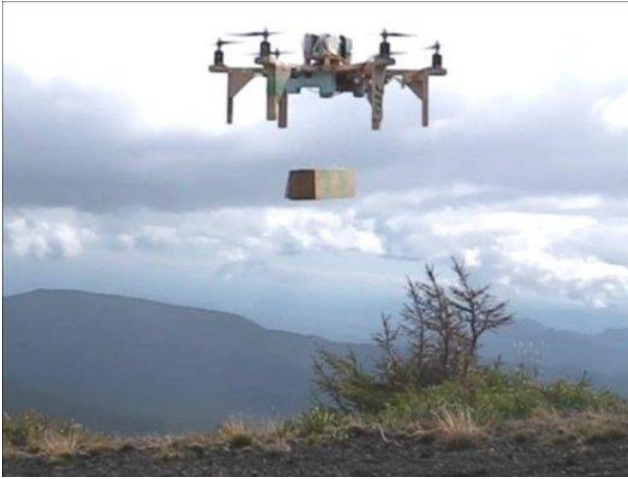
写真 2 飛行ロボットのペイロード投下試験
