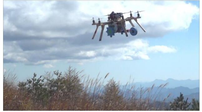
写真 4 飛行ロボット TOBI による移動ロボット運搬試験
